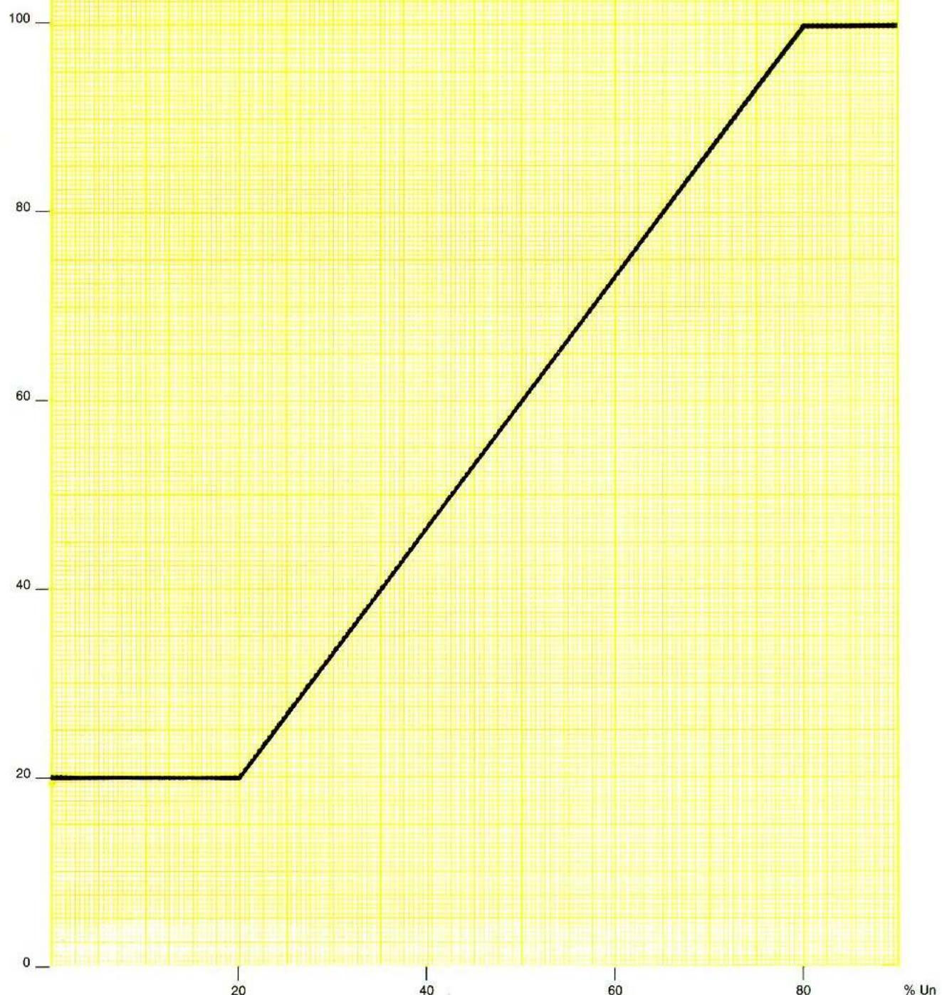
Fig. 5 : ITV 7000 - Evolution des seuils ampéremétriques en fonction de la tension
