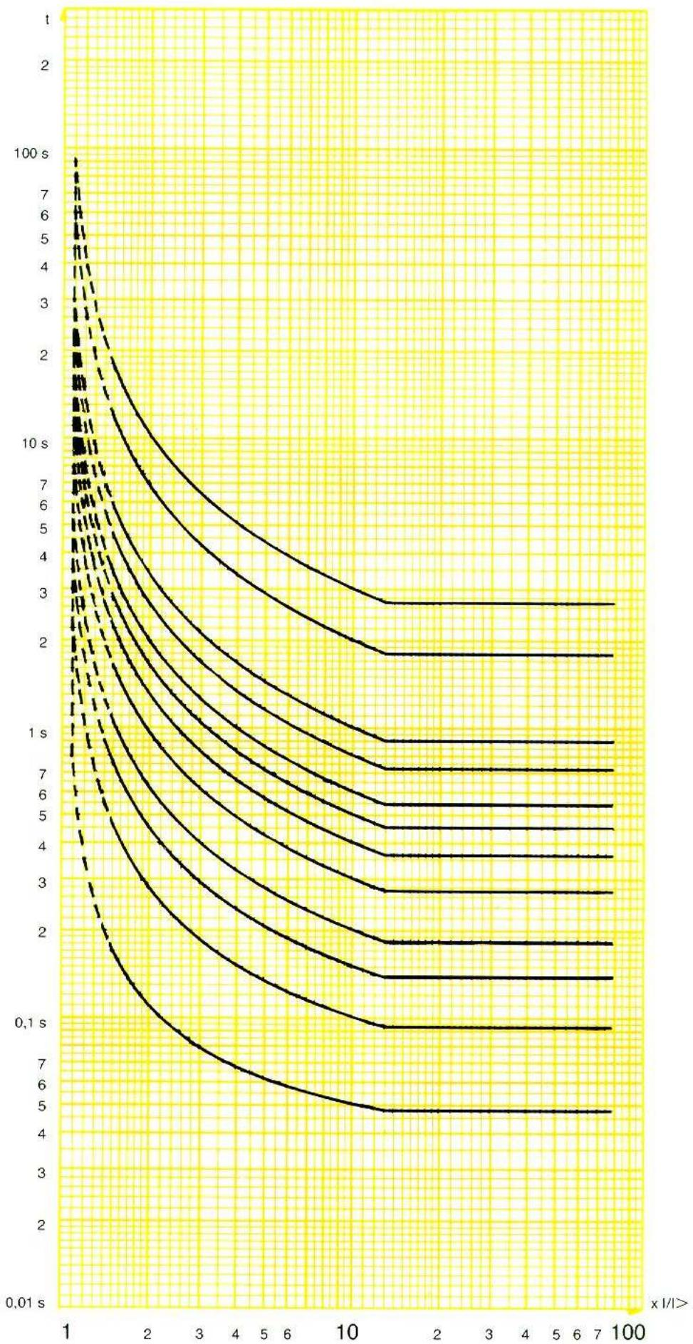
Fig. 2 : ITV 7266 - Courbes à temps inverse type A - CEI 255-4 pour 100%  $U_n$
