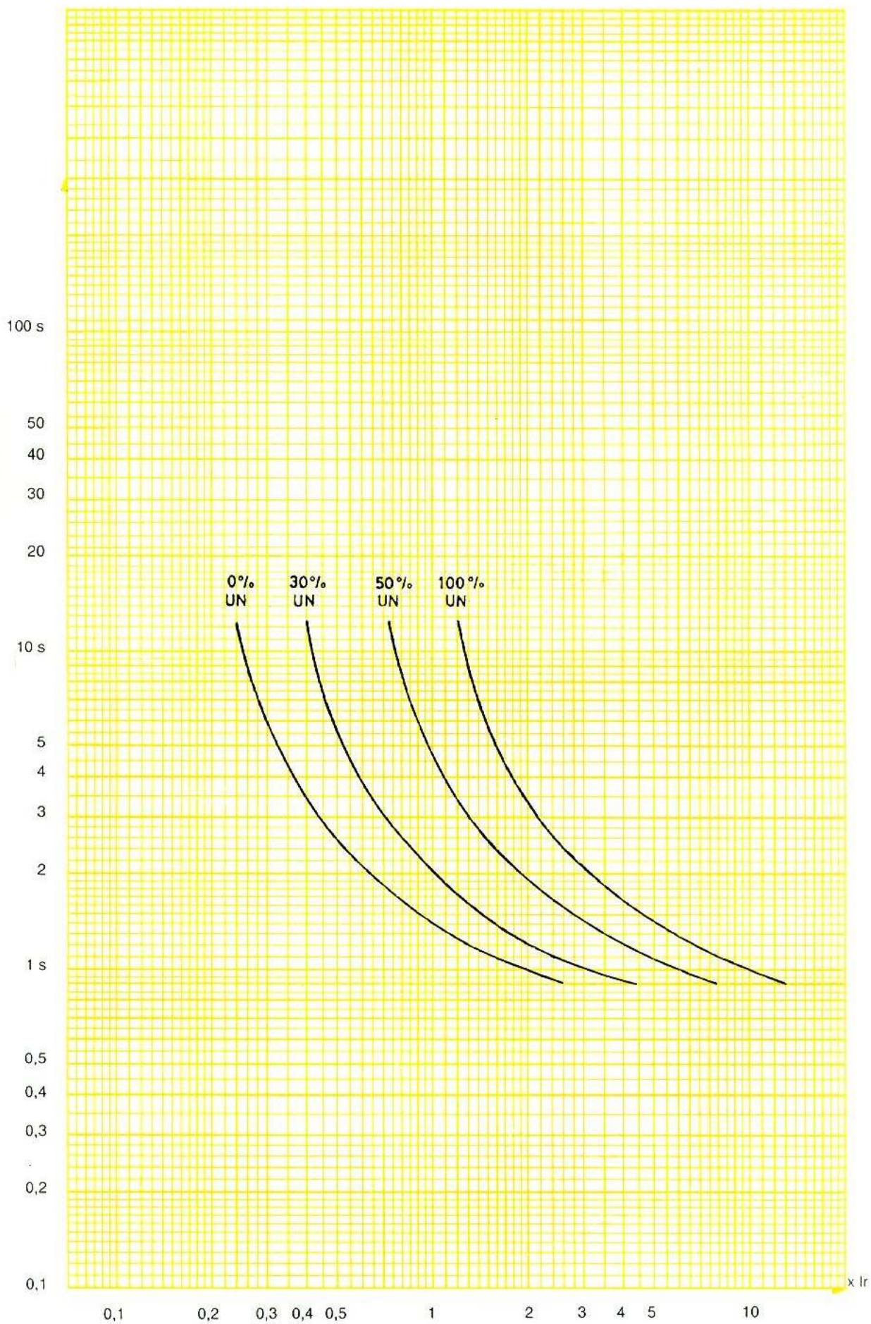
Fig. 6 : ITV 7266 - Exemple de diagramme de fonctionnement pour une courbe  $t(I>) = 1$  s en fonction de la tension
